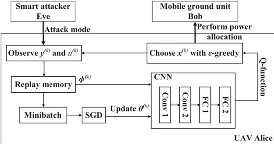
Fig. 4 DQN-based drone power allocation scheme
